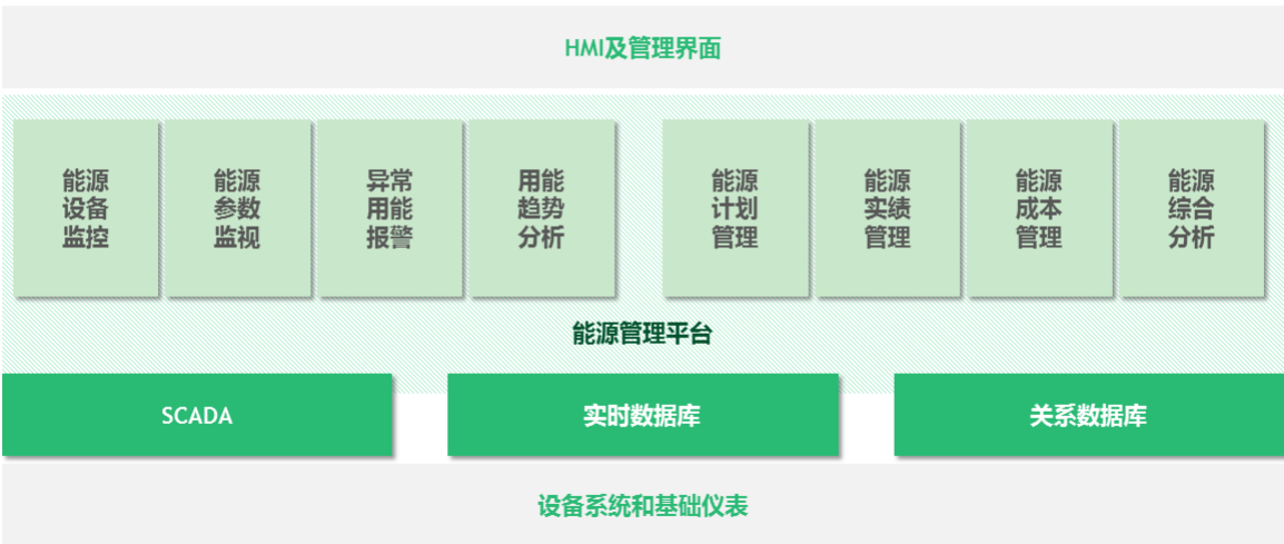
图4.4 电力和能源管理系统（PEMS）功能架构
